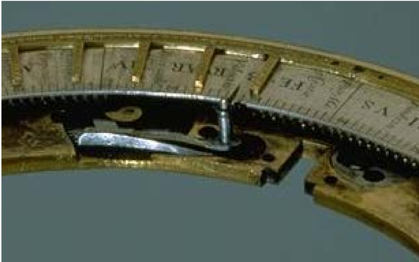
Horizontring mit automatischer Kalenderanzeige, Bild: Schüle
