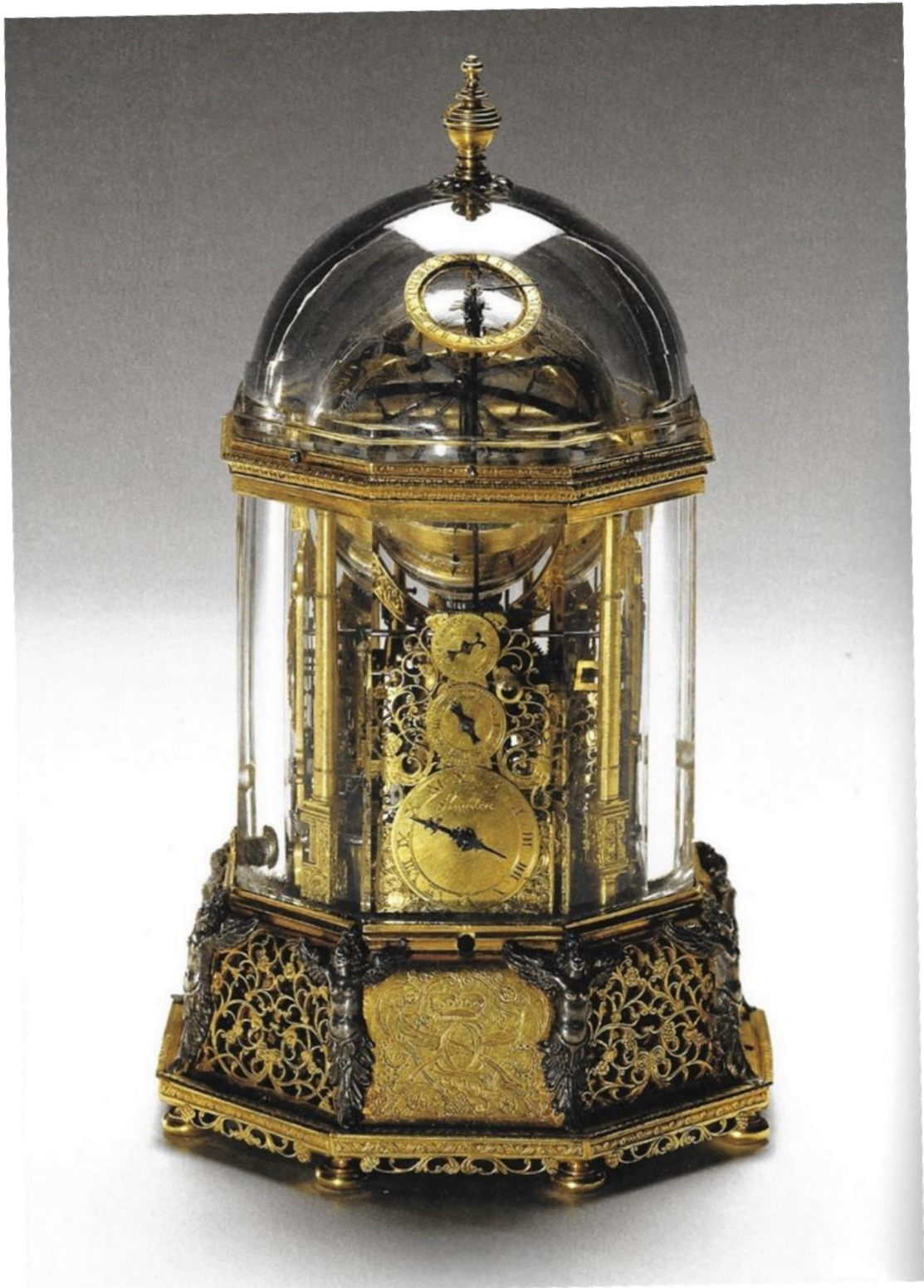
Vorderseite der astronomischen Bergkristalluhr mit Miniaturglobus, erstellt 1622/27 von Jost Bürgi im Auftrag von Karl von Liechtenstein und entlohnt mit 7'594 Gulden. Er schenkt sie dem Kaiser Ferdinand II. als Dank für die Aufnahme des Fürsten in den Orden vom Goldenen Vlies. Separate Anzeigefelder für Sekunde, Minute und Stunde. Im selben Jahr 1627 wird auch Johannes Keplers bedeutendstes Werk der «Rudolfinischen Tafeln» publiziert mit allegorischem Illustrationshinweis im Frontispiz [sS104]
